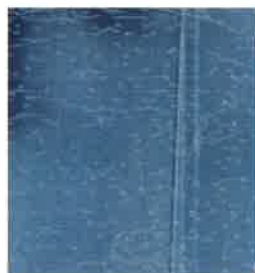
日射調整フィルムの金属膜劣化
